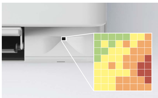
Der intelligente Thermo- und Bewegungssensor unterteilt die Raumoberfläche in 64 Quadrate, um ihre Temperatur genau zu bestimmen.
